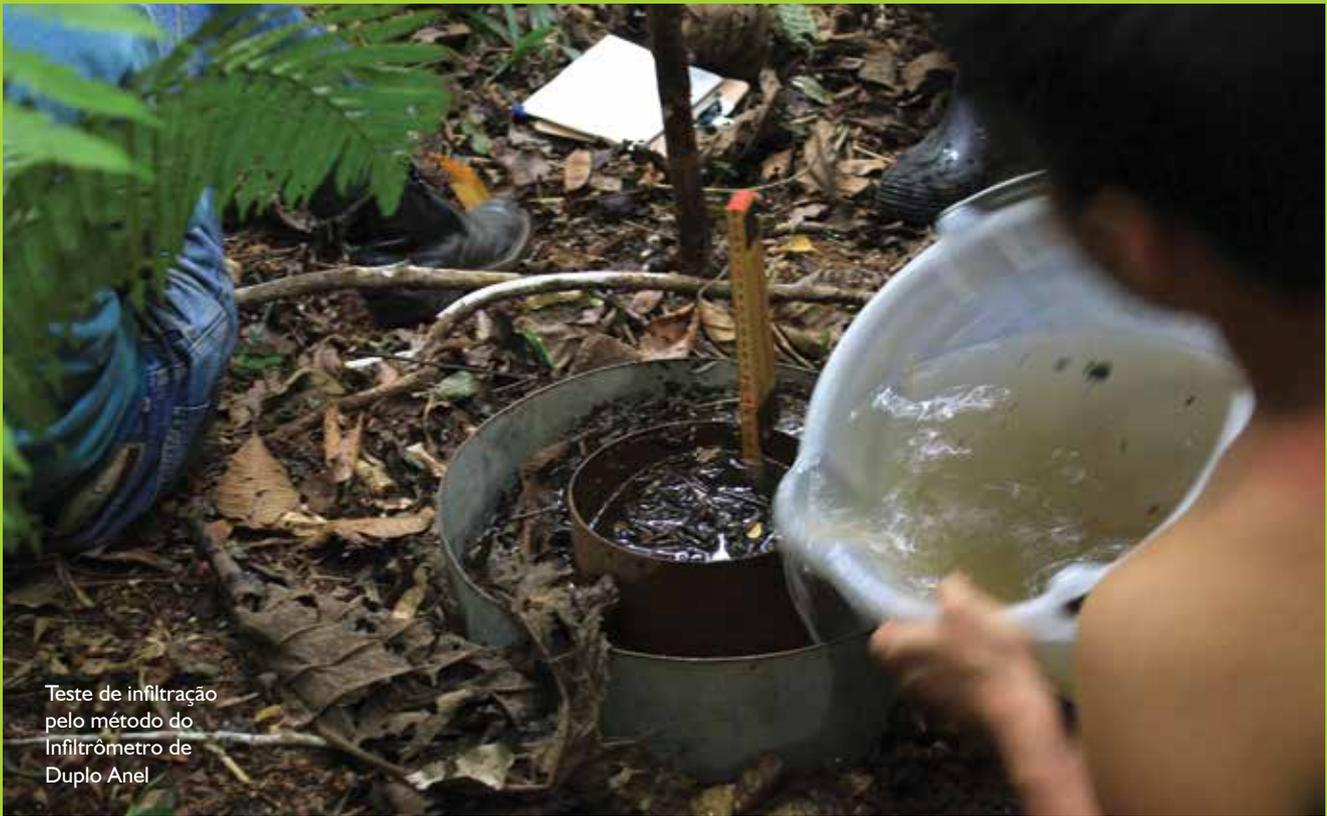
Teste de infiltração pelo método do Infiltrômetro de Duplo Anel
